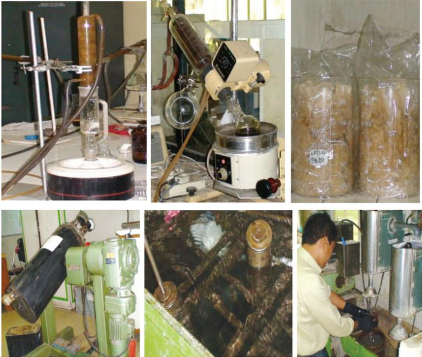
**Gambar 3.6 Proses Pembuatan Alfaselulosa**
